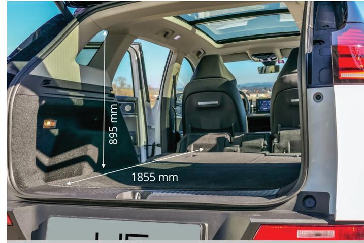
1675 Liter / litres / litri (dachhoch / jusqu'au toit / fino al tetto)
