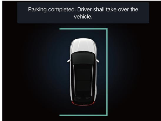
Après la manœuvre, le système active la fonction de frein de stationnement électronique et passe automatiquement sur le rapport de stationnement (P). Pour plus de sécurité, contrôler que le véhicule est garé sur la place prévue à cet effet.
