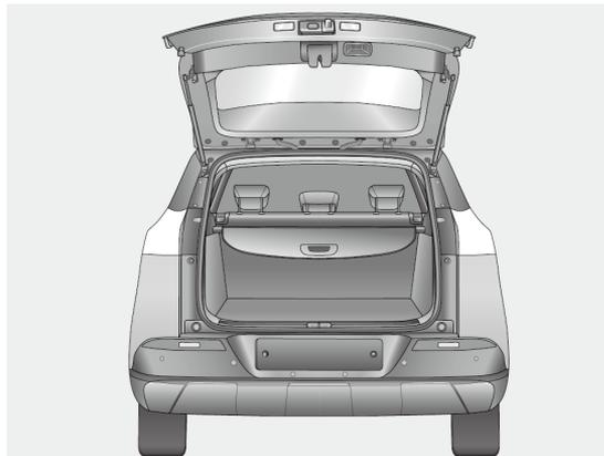
Lorsque la voiture est à l'arrêt, appuyer délicatement sur le bouton du hayon. Le hayon électrique s'ouvre automatiquement. Lorsque vous approchez la clé intelligente du hayon, votre voiture se déverrouille
