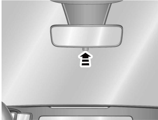
Votre voiture est équipée d'une fonction anti-éblouissement manuelle sur le rétroviseur intérieur. Pendant la conduite, si les feux de route de véhicules derrière vous sont trop éblouissants, vous pouvez appuyer sur la commande anti-éblouissement manuelle. Tirer la languette vers le haut pour désactiver la fonction anti-éblouissement.
